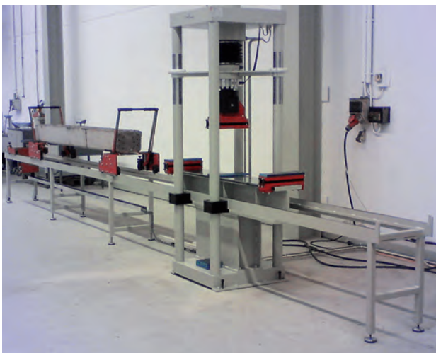
Prüfanlage zur Bahnschwellenprüfung Test plant for railway sleepers
