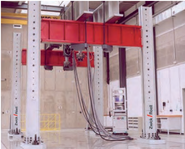
Spannfeld zur Prüfung großer oder speziell belasteter Bauteile Strong floor for testing large or specially loaded components
