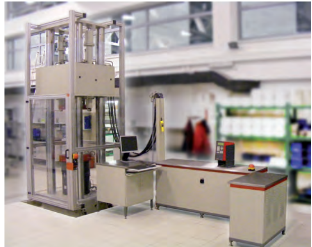
Hochlastige Baustoffprüfanlage mit automatischer Querhauptverstellung High capacity test plant with automated cross head adjustment
