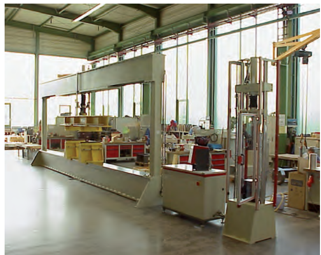
Universalprüfeinrichtung für Porenbetonbauteile Universal test plant for aerated concrete
