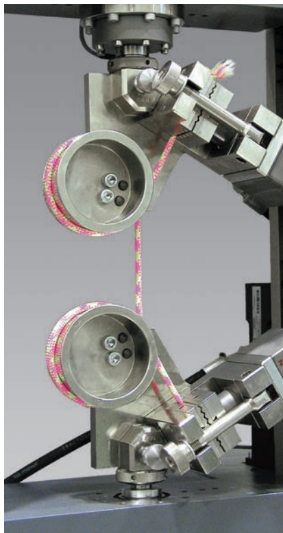
Fig.1. Tensile test on ropes
